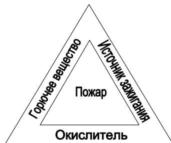
Рисунок 2 – Возникновение пожарной опасности
